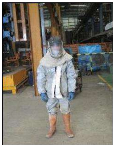
รูปที่ 2-41 การป้องกันอันตรายจากไอระเหยขณะปฏิบัติงานของพนักงาน
